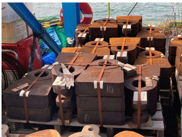
大型破碎機の刃：使用前
